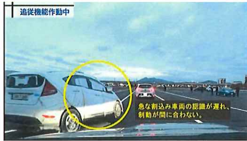
急な割り込み(全車速追従クルーズコントロール使用中)
